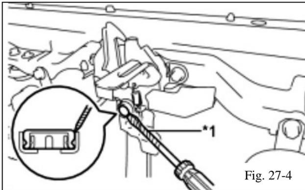
(d) Use a screw driver to remove the hood lock cap (Fig. 27-4).
